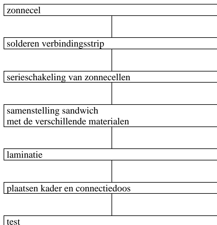
Figuur 3.23 Een schema van de modulefabricage.
