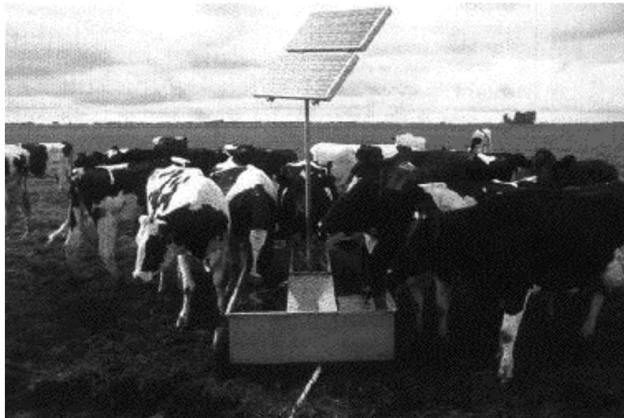
Figuur 4.13 Een eenvoudig pompsysteem voor de drinkwatervoorziening voor koeien in Nederland kan het gebruik van batterijen vermijden door het waterreservoir van de toepassing als 'energieopslag' aan te wenden (©foto Ecofys, NL).
